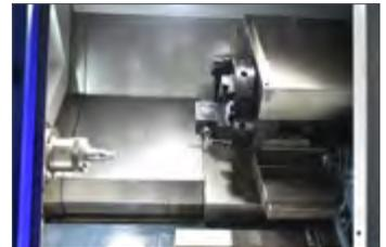
Наклонная цельнолитая станина из высококачественного чугуна, точные линейные направляющие качения. Подходит для серийного производства сложных, требующих высокой точности заготовок. Высокая степень автоматизации за счет расширенных опций и оснастки.
