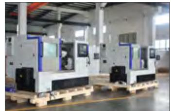
Оборудование с широким функционалом для чистовой и получистовой обработки деталей из черных и цветных и нержавеющей металлов, внутренних и наружных поверхностей заготовок, винторезных операций и нарезания резьб.
