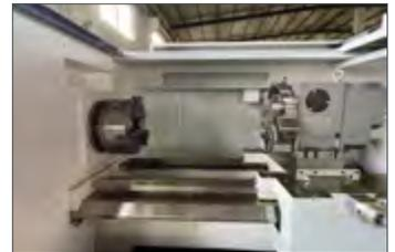
Станки данной конструкции работают в тяжелых условиях эксплуатации, отличаются повышенной стабильностью. Могут оснащаться подвижными и неподвижными люнетами, что необходимо для обработки длинных заготовок без прогиба.
