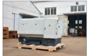
Станина из высококачественного чугуна, закаленные и точные направляющие. Высокая жесткость и большой интервал между направляющими станины гарантируют высокую точность при обработке габаритных заготовок из металла, труб. Подходит для мелкосерийного и среднесерийного производства сложных, требующих высокой точности заготовок.
