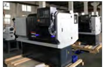
Самая доступная модель токарного станка с ЧПУ для точения длинных заготовок, деталей типа «вал». Жесткая чугунная станина и направляющие скольжения обеспечат высокую точность позиционирования и обработки.
