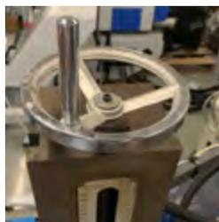
Механическое перемещение оси Z
