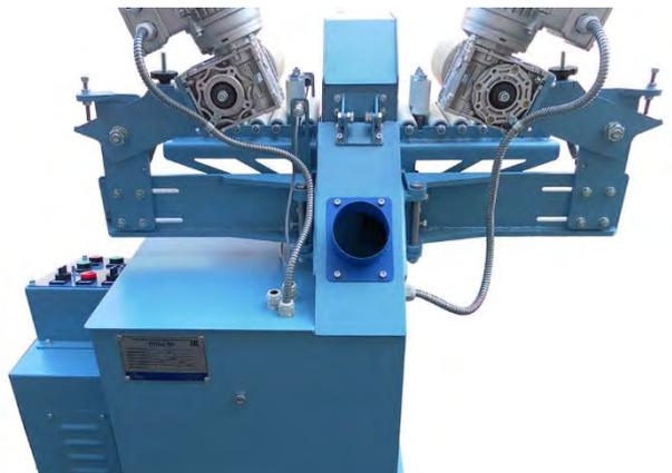
Для удаления древесной пыли предусмотрен вывод для подключения аспирационных установок.
