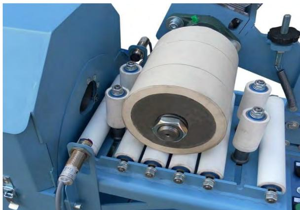
В автоматическом режиме, при прохождении заготовки через датчики, происходит остановка привода диска. В этот момент заготовка заходит в рабочую зону и привод диска возобновляет работу.
