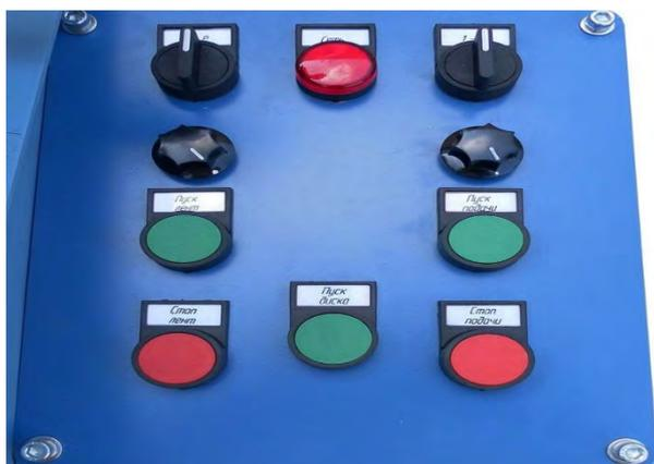
Простое управление станком. Левый ряд переключателей запускает работу шлифовальных лент, регулирует скорость и режим подачи (автоматический или ручной). Правый – работу механизма подачи, скорость, направление подачи.
