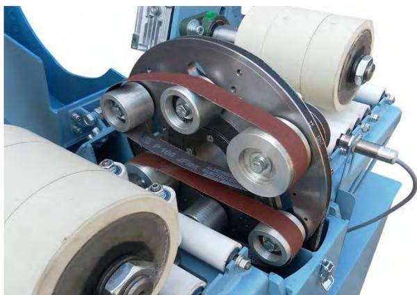
Планетарный принцип работы станка, выполняет одновременное вращение вокруг заготовки шлифовальных лент и приводного диска, таким образом достигается отличное качество обработки поверхности детали при шлифовке и полировке.
