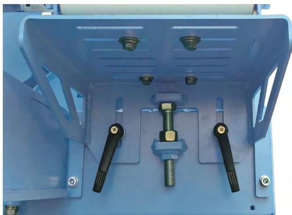
Легкая настройка высоты подающего стола по высоте. Нужно всего лишь ослабить два винта и вкрутить или выкрутить регулировочный болт на нужную высоту стола.
