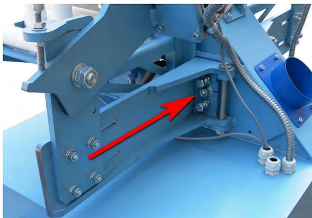
Для перехода в ручной режим работы, нужно отвести подающие ролики в сторону. Для этого необходимо открутить фиксирующие болты.
